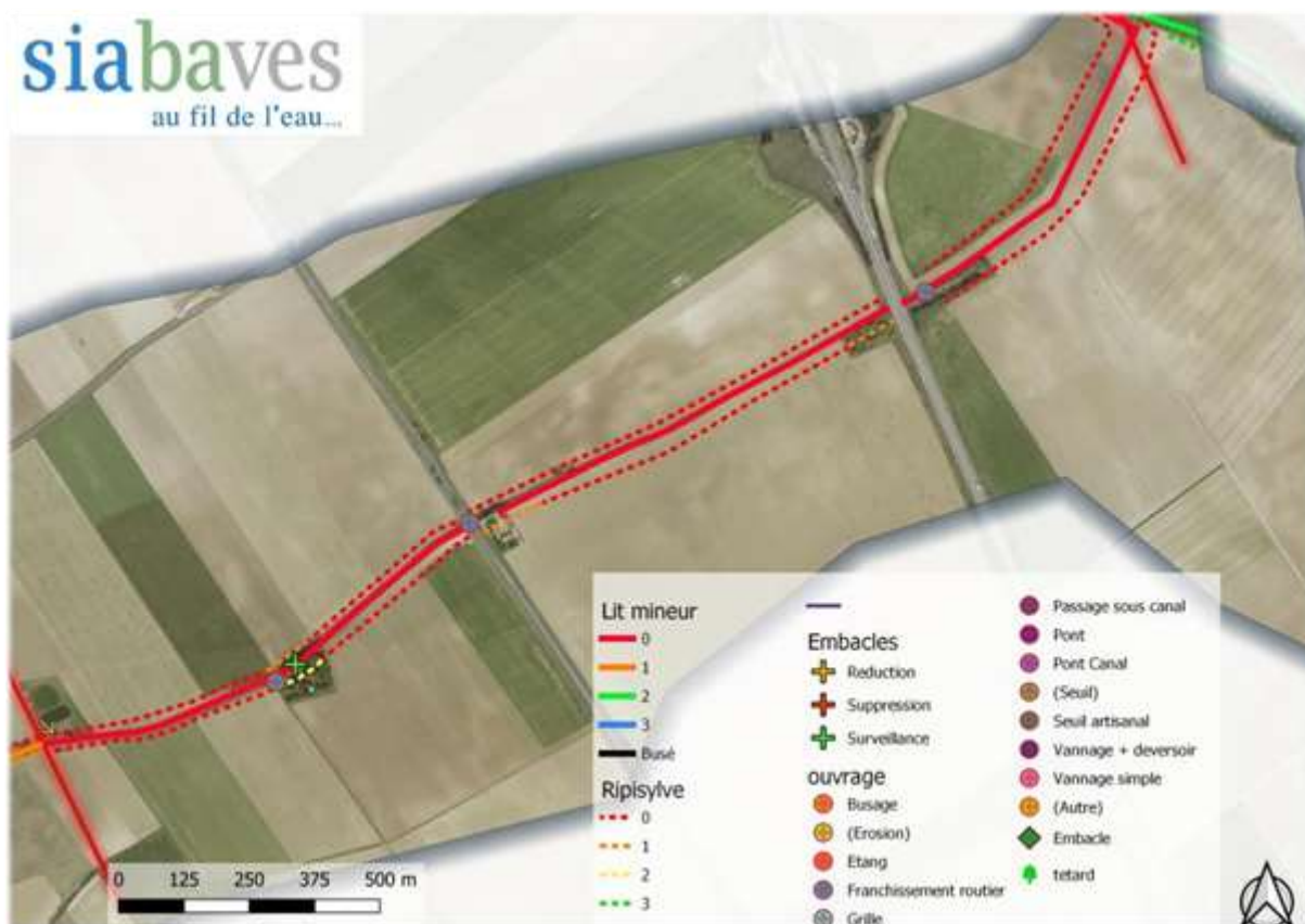
Figure 72 : Synthèse des observations réalisées sur le tronçon n°6 du de la Rabassa
